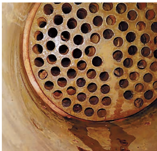
«Форсел» после 7 месяцев непрерывной работы (внутренние поверхности)
