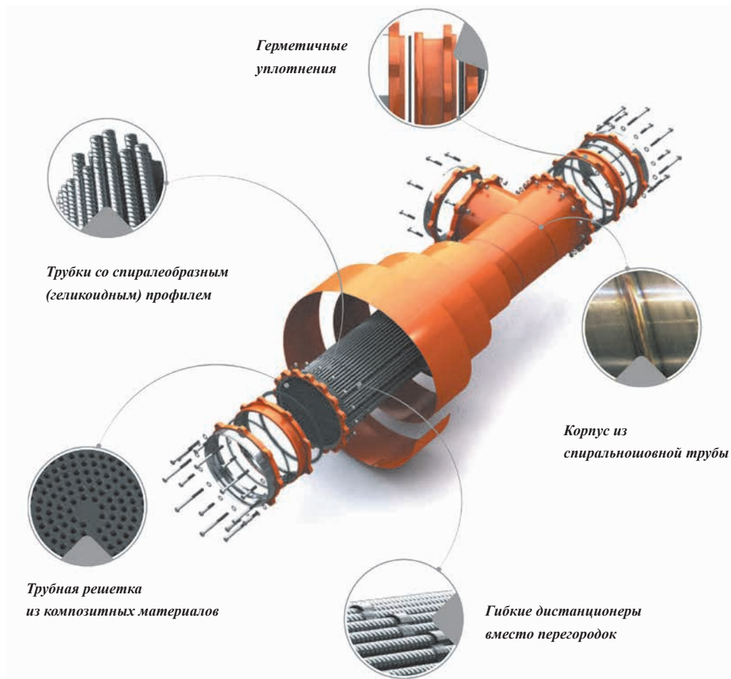
Конструкция теплообменного аппарата «Форсел»
