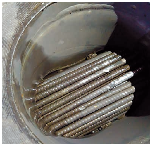
«Форсел» после 7 месяцев непрерывной работы (внутренние поверхности)
