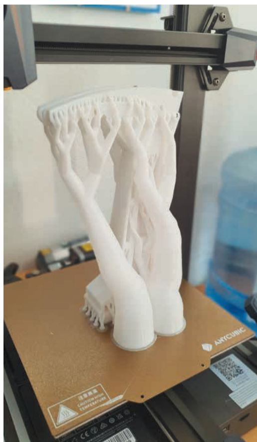
Процесс печати соединительного узла изоляционной тяги для выключателей на 3D-принтере
